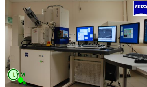
Microscope à faisceau d'ions focalisé (FIB) double-colonne ionique / électronique
